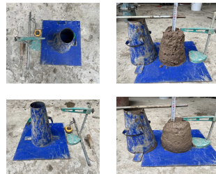
Slump Test : KS F 2402
